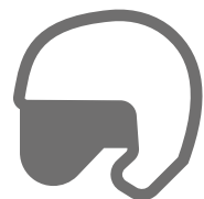
Calotta esterna in materiale termoplastico
